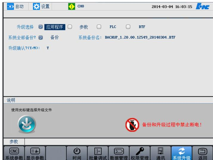
**注意：**参数升级只针对调试人员使用，在参数结构文件发生改变后，在对参数进行一次升级。
