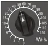
在自动方式或 MDI 运行方式下，当 F 代码编程的进给速度偏高或偏低时，可旋转进给修调波段开关，修调程序中编制的进给速度。修调范围为 0%-120%。
