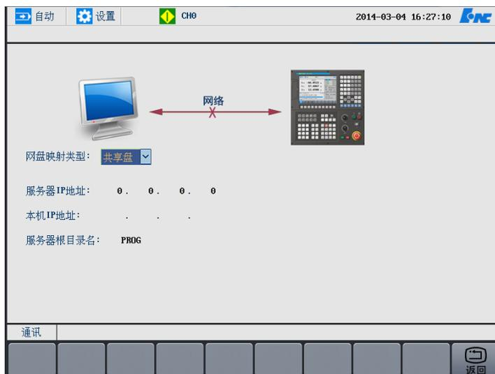
d) 光标移至服务器 IP 地址，按“Enter”键，输入共享文件夹所在的 PC 机的 IP 号；
