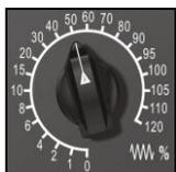
在自动方式或 MDI 运行方式下，当 F 代码编程的进给速度偏高或偏低时，可旋转进给修调波段开关，修调程序中编制的进给速度。修调范围为 0%-120%。
