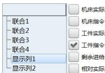
坐标图形显示区域(2)大字坐标显示设置，可通过按“维护”功能集界面下『用户设定』软键，进入下级菜单，再按『显示设定』软键，进入其下级菜单，选择“显示列 1”及“显示列 2”的选项，设定“大字坐标+程序”界面中大字坐标内容（详见 3.6.8 节“用户设定”说明）。
