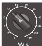
自动运行程序中没有指定进给速度，且“手动 MS”功能未开启，系统按通道参数“缺省进给速度”040030 设定的值运行；若开启了“手动 MS”功能，则按“手动 MS”中配置的速度运行，运行过程中进给速度修调均有效。
