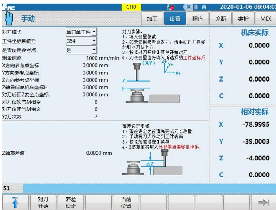
“自动对刀”功能界面目前支持单刀单工件测量、单刀多工件测量以及多刀多工件测量三种自动测刀长功能。为满足三种不同应用场景，将所测刀长值存储的位置均有不同。单刀单工件测量将刀长值存入所选工件坐标系，Z 落差值填入外部零点偏移；单刀多工件测量将刀长值存入外部零点偏移，Z 落差值填入所选工件坐标系；多刀多工件测量将刀长值存入刀补表，Z 落差值填入所选工件坐标系。
