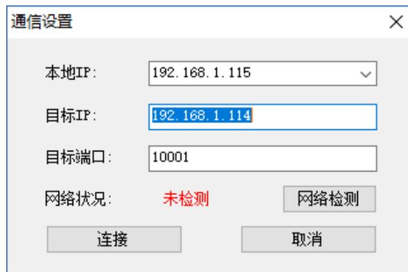
正确填写本机 ip 和系统 ip 后点击连接。
