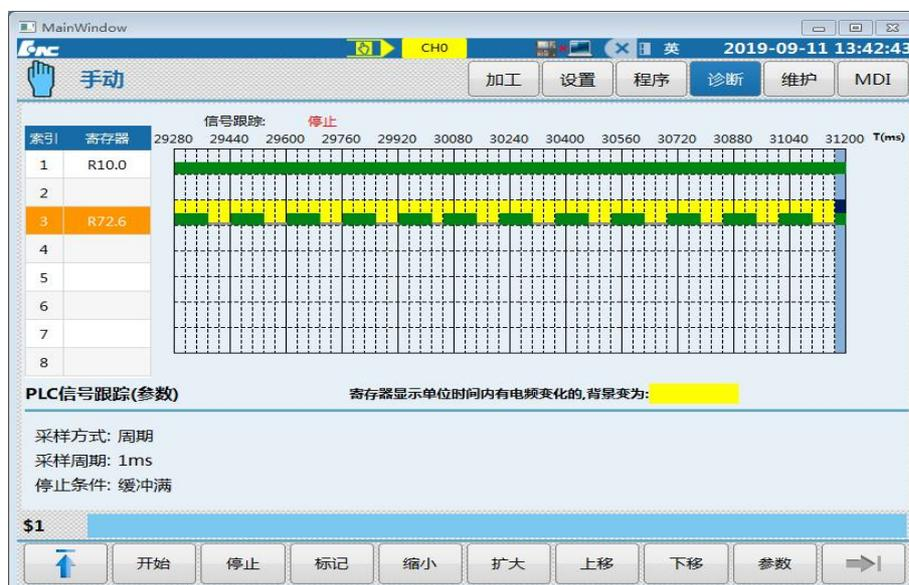
参数界面，可以控制采样功能的开启条件，例如在上述例子中将开始条件改成触发开始，触发条件改成 X483.7，那么点击开始后不会有采样开始，而是按一次 X483.7 的按键，才会开始采样，而停止改成触发停止，停止条件为 X483.6，则按停止按键和 X483.6 的按键都可以停止采样。
