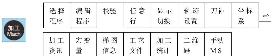
**选择程序：**从目标盘中（系统盘、U 盘、用户盘、网盘）选择程序加载为加工程序；也可通过后台编辑，选择程序进行编辑；以及编辑新创建的程序。
