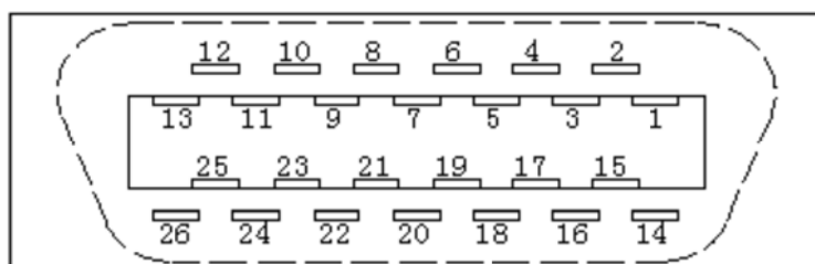
伺服电机编码器输入接口插头的焊接脚 (面对插头的焊接脚看)
