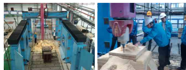
东汽集团五坐标联动龙门加工机床，在双电机同步驱动下，可达到最高移动速度80米/分
