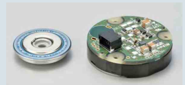
多圈绝对值编码器“MAR-M50A” 图片左边：内部构件——M序列标尺 图片右边：机身外观
