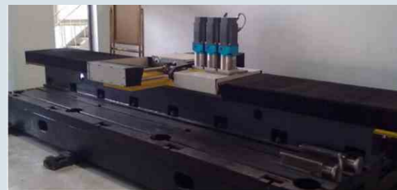
3进给轴同步消隙机械结构
