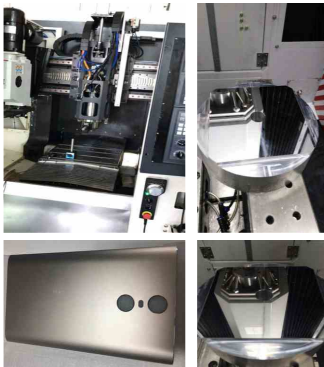
配置EtherCAT高速总线和直线电机的高光机和加工的零件
