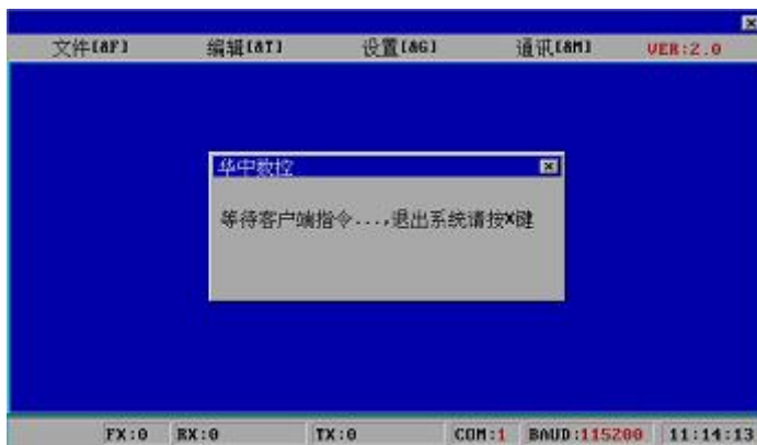
图 4.2.11 数控系统端串口通讯主界面
