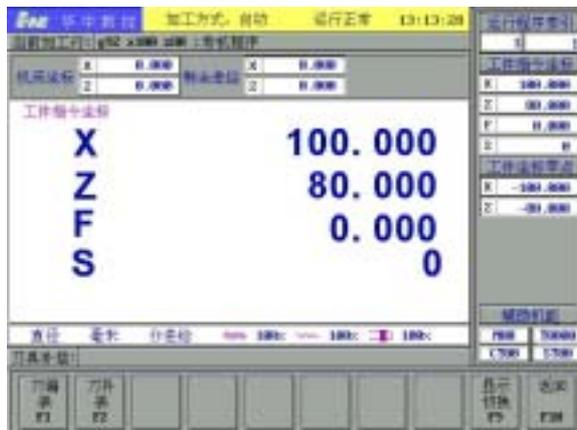
图 6 HNC-21T 车床系统刀具补偿子菜单
